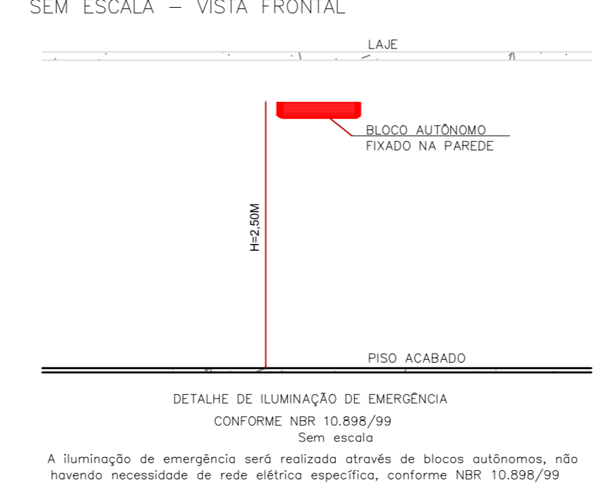
DETALHE - ILUMINAÇÃO DE EMERGÊNCIA (I.T.-13) SEM ESCALA - VISTA FRONTAL
